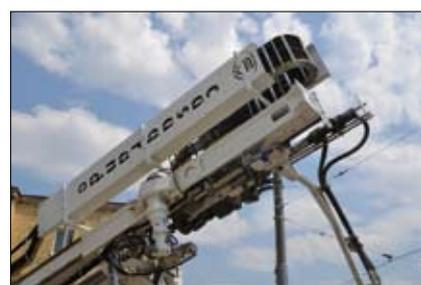
La Casagrande ha fornito a I.CO.P. la perforatrice C8XP equipaggiata con un caricatore a carosello M4 in grado di contenere fino a nove aste da 6 m di lunghezza ciascuna, più una batteria di manovra da 8 m. Al momento della nostra visita, la macchina stava utilizzando sei aste, operando con tecnologia jet-grouting bifluido
