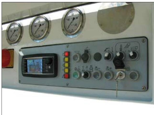
Le operazioni di jet-grouting vengono svolte tramite radiocomando, dopo averle impostate con un apposito strumento di misurazione e di registrazione dei parametri
