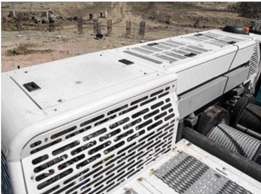
La progettazione della B300XP ha visto lo spostamento verso l'alto dello scambio termico.
