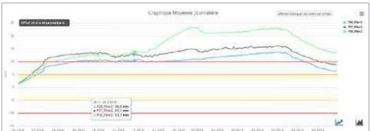
Figure 19 : Extrait du logiciel d'auscultation « geoscope»: soulèvements dès le début de la congélation et tassement à la décongélation. - Extract from the "geoscope" survey software: heaving from the start of the freezing and settling during thawing.
